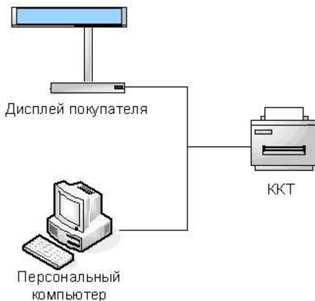
Рисунок 3. Подключение управляющих устройств к ККТ
